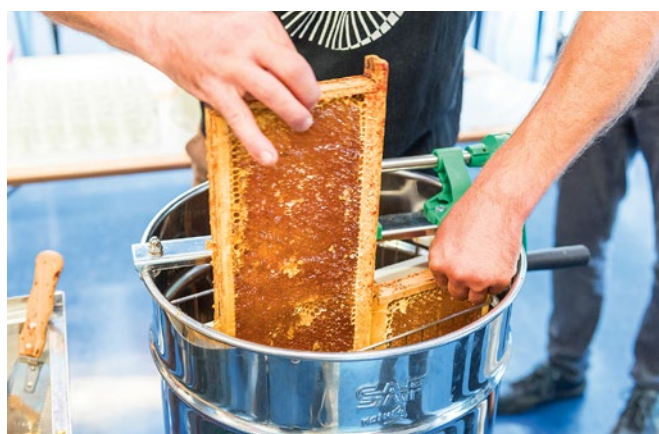
Centrifugeuse Dans la machine, le miel s'écoule des rayons.
